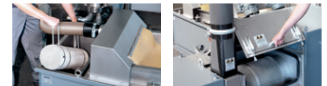
Neues Granulatentwässerungssieb und neue Granulatentrifuge
