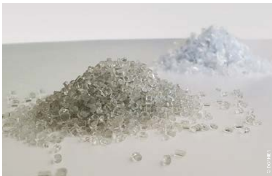
El reganulado ha sido optimizado para obtener el mayor rendimiento posible en la línea de estiramiento de la película.
