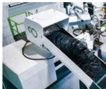
Como máquina polifacética en cuanto a materiales, la máquina ISEC evo procesa voluminosos conjuntos de mangueras, así como coladas y restos de producción o rollos completos con cintas de goteo.
