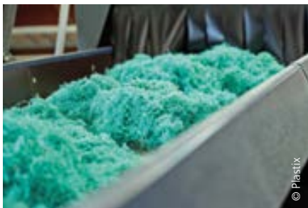
Solo cuando los materiales residuales han sido separados por tipo y color con la mayor precisión posible, triturados y lavados, se transfieren a la línea de regranulación.
