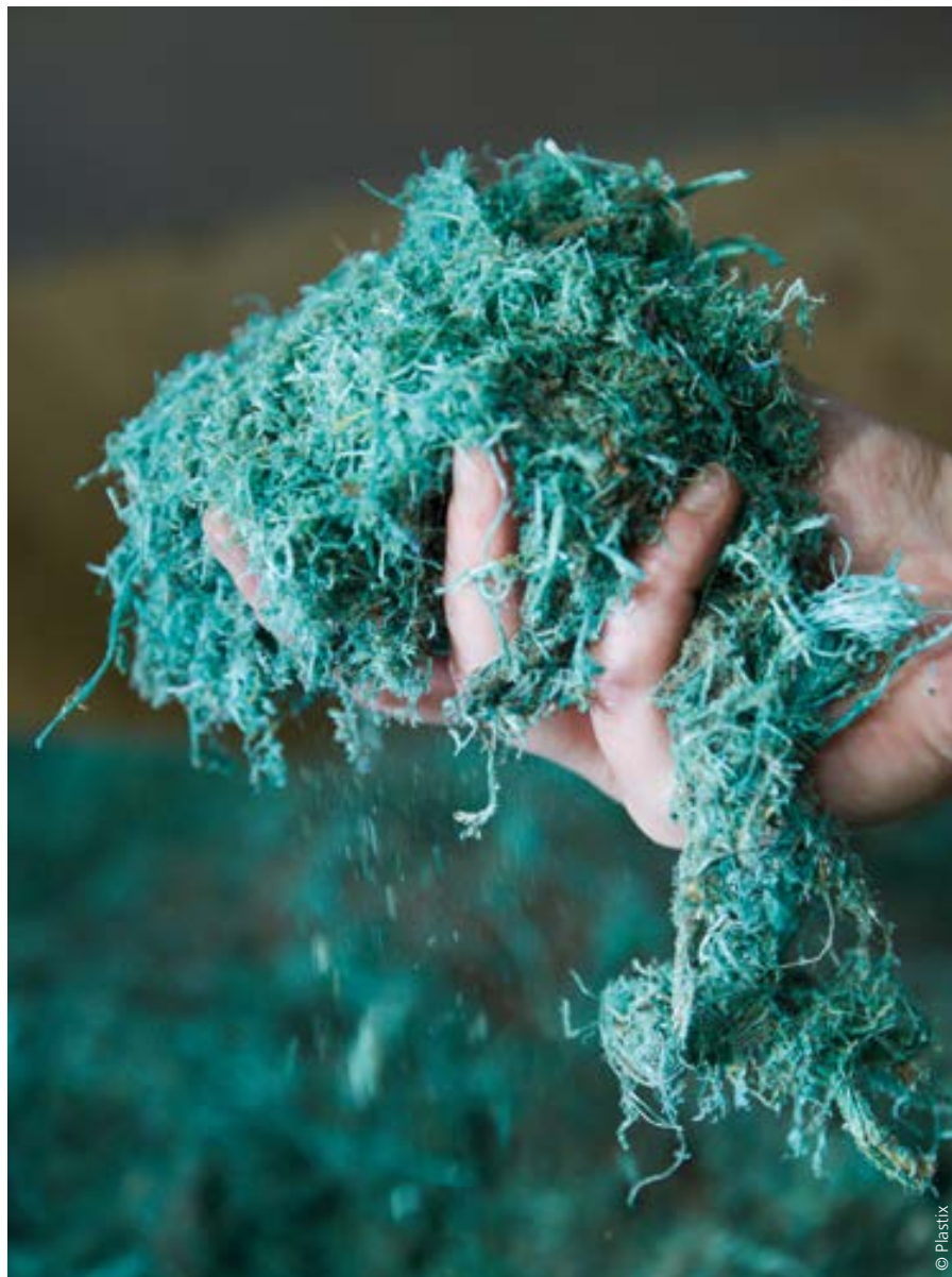
Solo cuando los materiales residuales han sido separados por tipo y color con la mayor precisión posible, triturados y lavados, se transfieren a la línea de regranulación.
