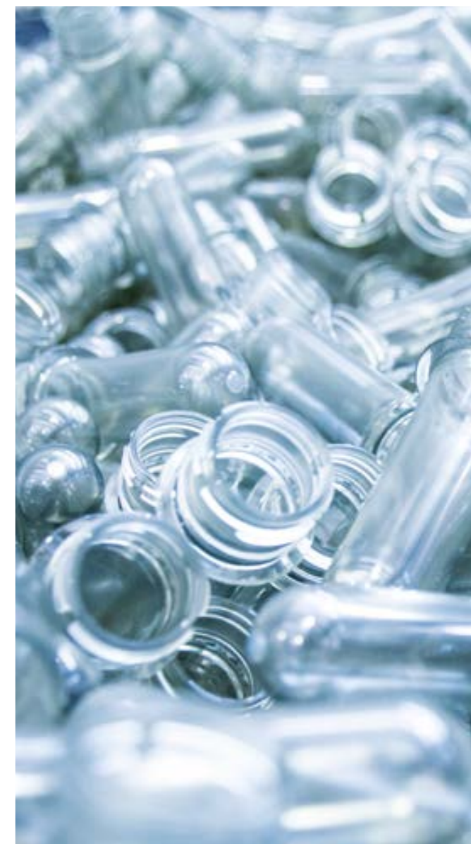
Con la instalación de preformas en línea de PET se puede procesar directamente las escamas de PET para transformarlas en preformas en línea aptas para el consumo alimentario en un solo paso.
