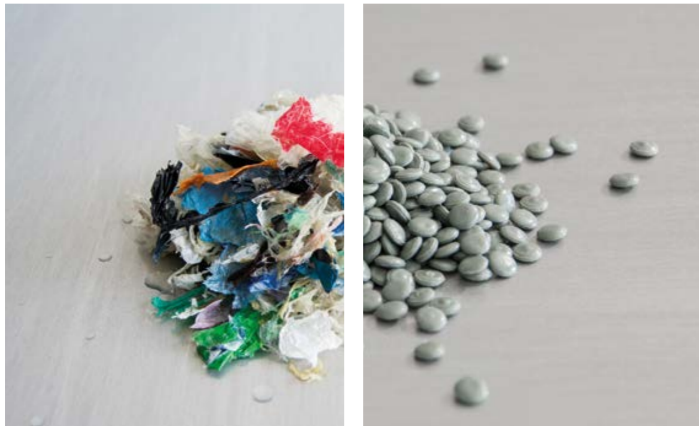
A la izquierda, el material de entrada; a la derecha, el de salida: la INTAREMA® TVEplus® domina el proceso de transformación que hay entre las dos imágenes, gracias a la eficiente filtración doble integrada y al paquete de homogeneización de alto rendimiento.
