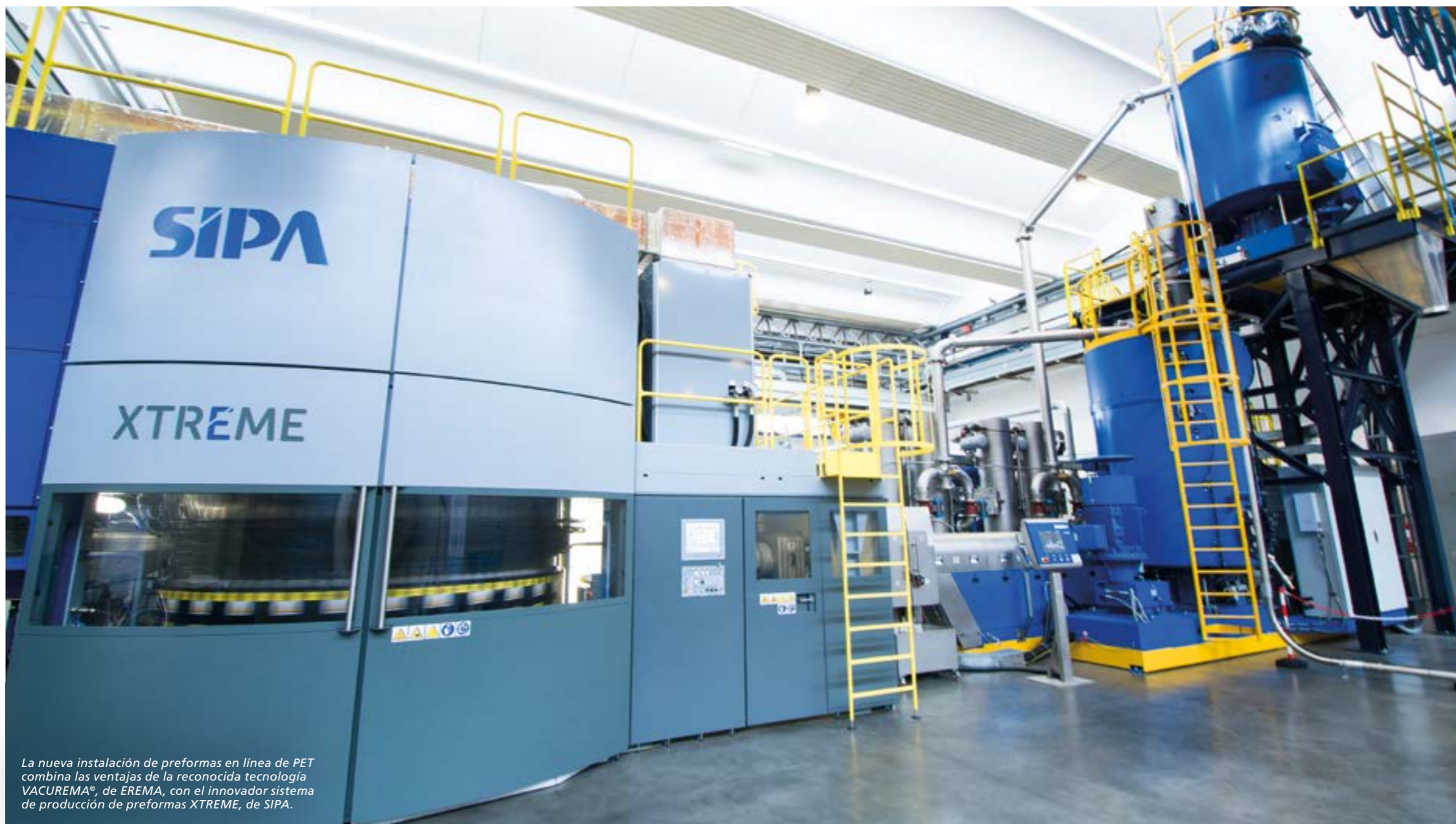
Con la instalación de preformas en línea de PET se puede procesar directamente las escamas de PET para transformarlas en preformas en línea aptas para el consumo alimentario en un solo paso.
