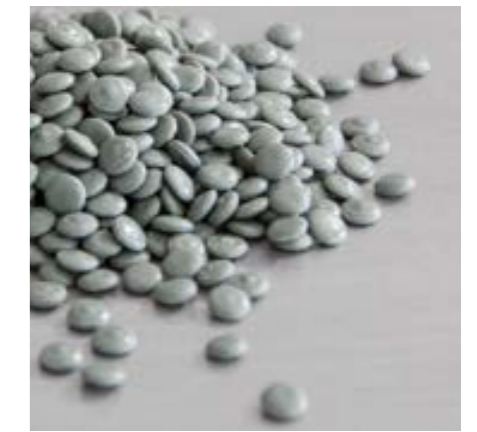
Izquierda: Además de la gran contaminación, el material de post-consumo del ámbito doméstico presenta también un intenso olor. Derecha: Granza de alta calidad con optimización del olor: el resultado de la combinación tecnológica de la INTAREMA® TVEplus® con el subsecuente proceso del ReFresher
