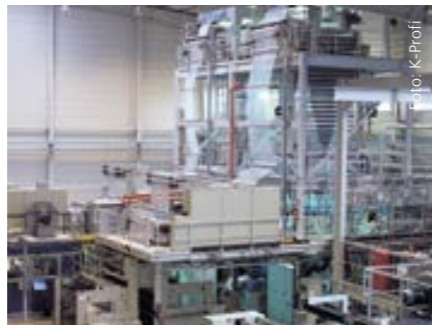
15.000 t/a flexible Folien mit 3 bis 14 Schichten stellt der Kunststoffverarbeiter auf insgesamt acht Blasfolienextrusionsanlagen selbst her.
