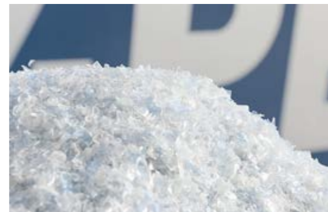
Zur Produktion lebensmitteltauglicher rPET-Tiefziehfolie (Bild unten links) setzt Snelcore vorwiegend Post Consumer Bottle-Flakes (Bild links) ein. Dank der hohen Flexibilität der verwendeten VACUREMA® Technologie können als Eingangsmaterial jedoch auch Randstreifen-Abfälle (Bild rechts), Stanzgitter oder Neuware zugemischt werden.
