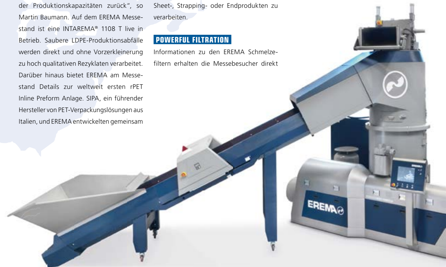
EREMA auf der NPE: Auf dem Messestand werden auf einer INTAREMA® 1108 T saubere LDPE-Folienabfälle im Live-Betrieb zu hochwertigen Rezyklaten verarbeitet.
