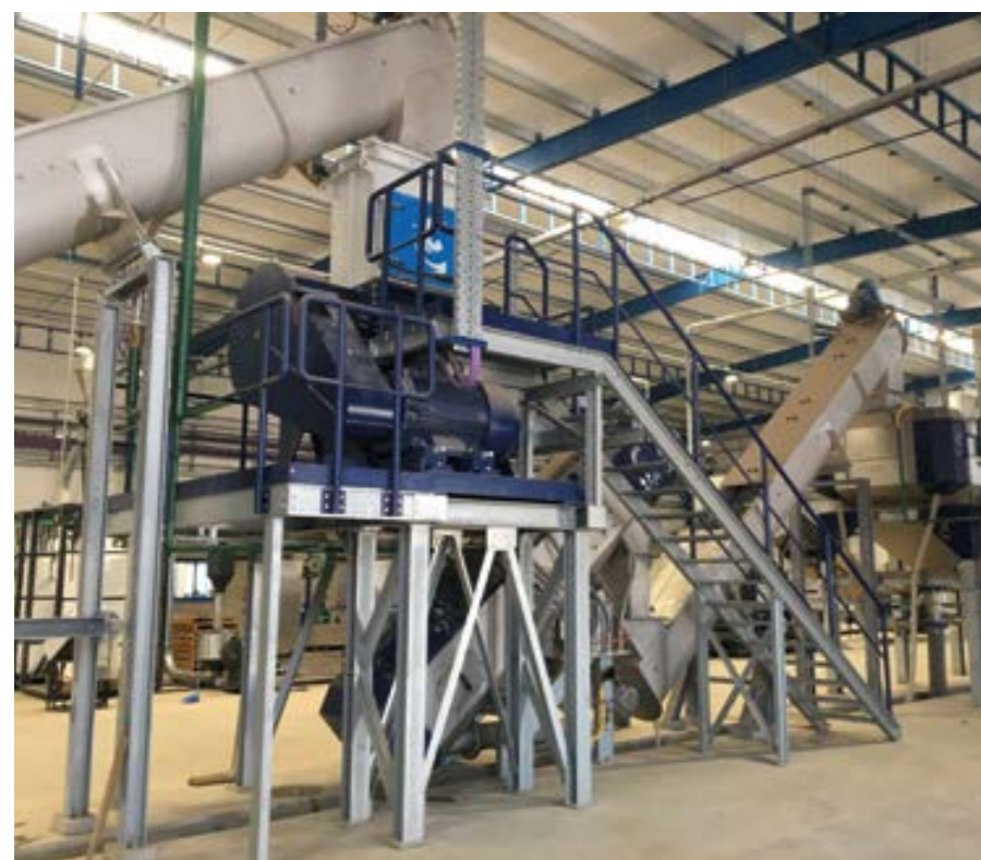
Künftig steigt Enviroplast auch in das Recycling von Post Consumer Materialien ein und setzt dabei auf eine Lindner Waschanlage mit einer Leistung von 1.000 bis 1.500 kg/h (im Bild). Die Extrusion dieser Materialien erfolgt auf einer INTAREMA® 1512 TVEplus® mit Laserfilter.
